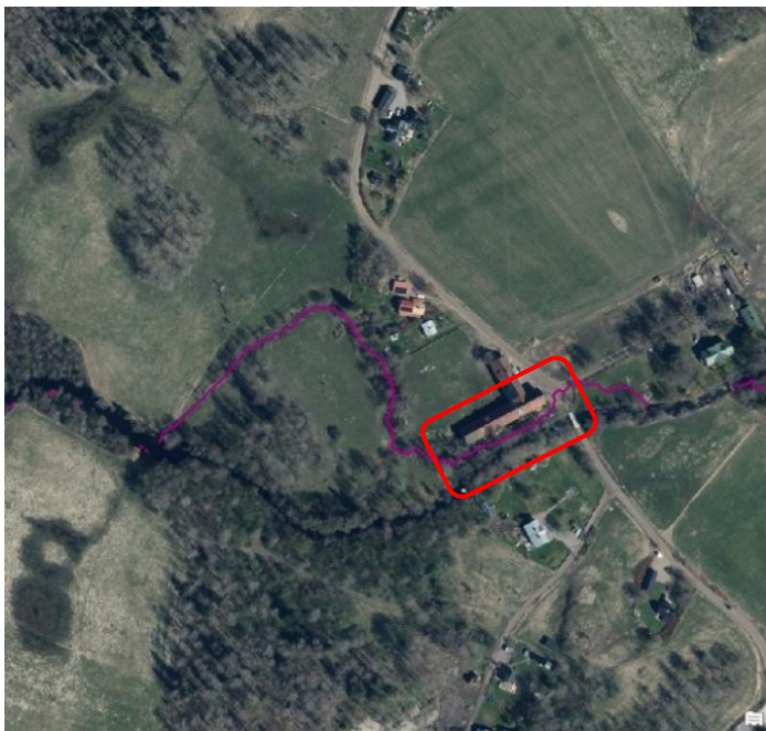
Figur 3.2.3.2 Flödeslinjen som avviker från vattendraget vid den stora byggnaden går tydligt på marken.
