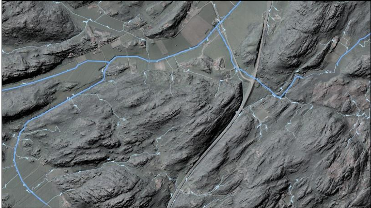
Figur 1.2.5.1 De tjockare linjerna representerar Hydrografi i nätverk och de tunnare Flödeslinjerna
