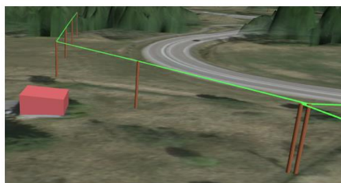
Figur 3.1c Exempel på kraftledning visualiserad genom längsgående och vertikala linjer. Den längsgående linjen konstrueras mellan redovisade brytpunkter och de vertikala lin-
