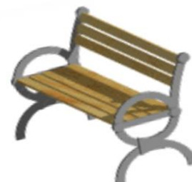
Figur 3.1a Exempel på parkbänk visualiserad med 3D-symbol. Symbolens utbredning tas från redovisad polygon och höjden från attributet relativ höjd. Attributet variant kan användas för att exempelvis ange typ av bänk i fritext och därmed styra symbolen utseende. (3D-symbolen till höger är hämtad från https://bimcomponents.com/GSM/Details/7298 .)
