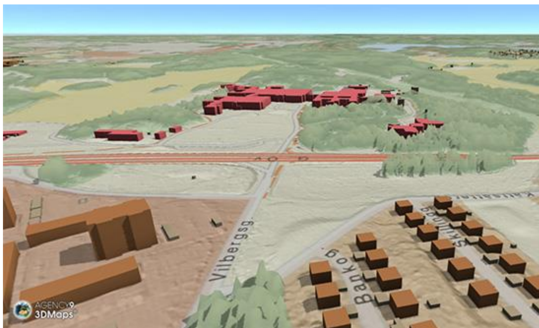
Figur 5.1.1.2b Träd/skog kan beskrivas som enskilda träd eller ytmodell (DSM) eller trädhöjd (ytmodell minus markmodell) beroende på syfte – i bilden ovan är skogen en färgsatt ytmodell som "svävar" över markmodellen.
