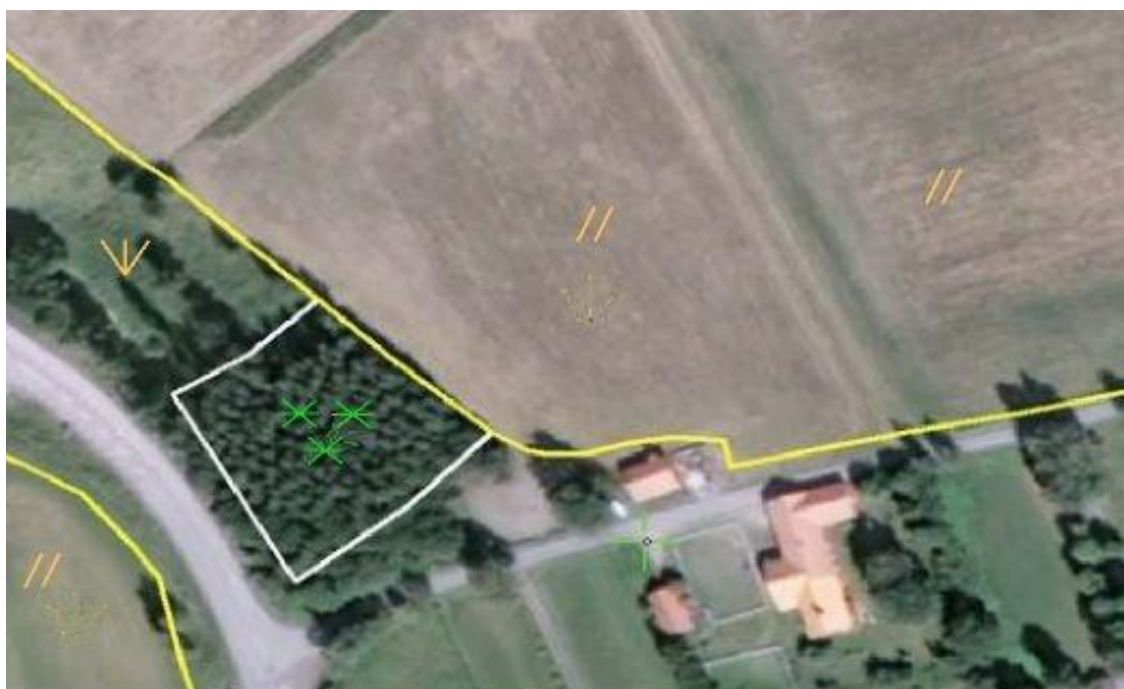
Figur 4.6 Exempel på övrig marklinje med koden marktäckegräns (vit linje) respektive markanvändningsgräns (gul linje). Kartbeteckningarna/symbolerna kommer från HMK-Kartografi 1996, Bilaga D och avser barrskog (grön symbol) samt ängsmark respektive åkermark (gulbruna symboler). Om ytbildning och kodning önskas för marktäcke och markanvändning sätts centroid och, vid behov, tätningsslinjer, se avsnitt 6.1.2.
