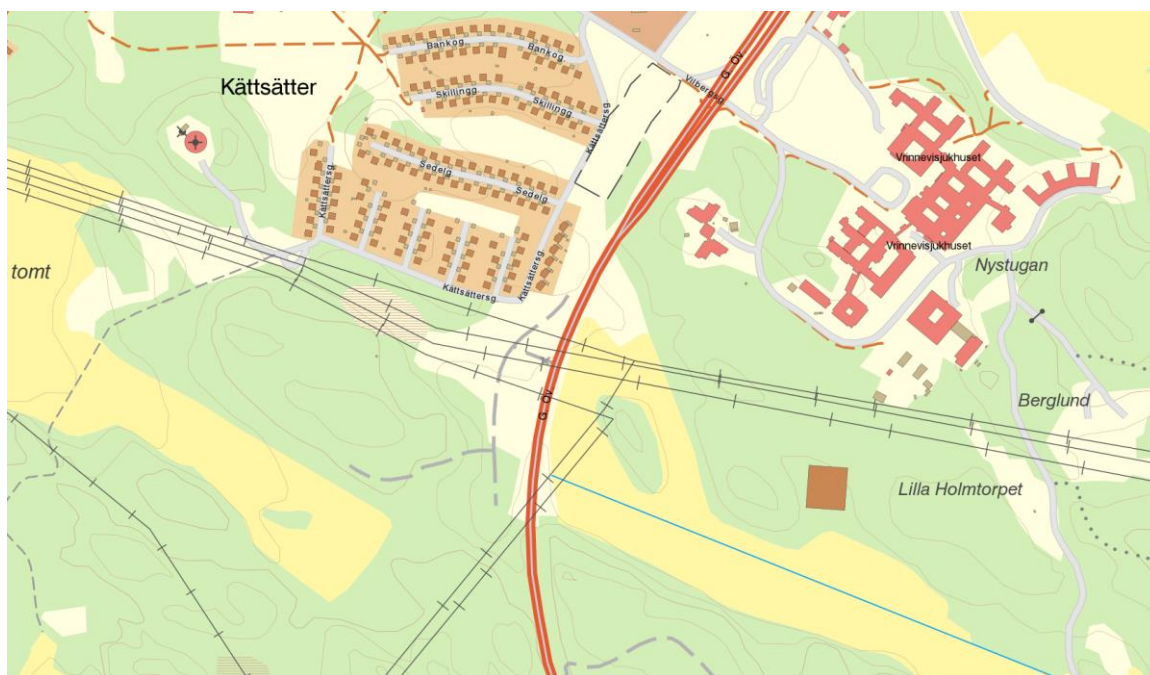
Figur 11e Utdrag ur Lantmäteriets Topografiska webbkarta, visning i 2D, dvs baserad på geodata i HMK-standardnivå 1. I figur 11f kan motsvarande vy ses i 3D.
