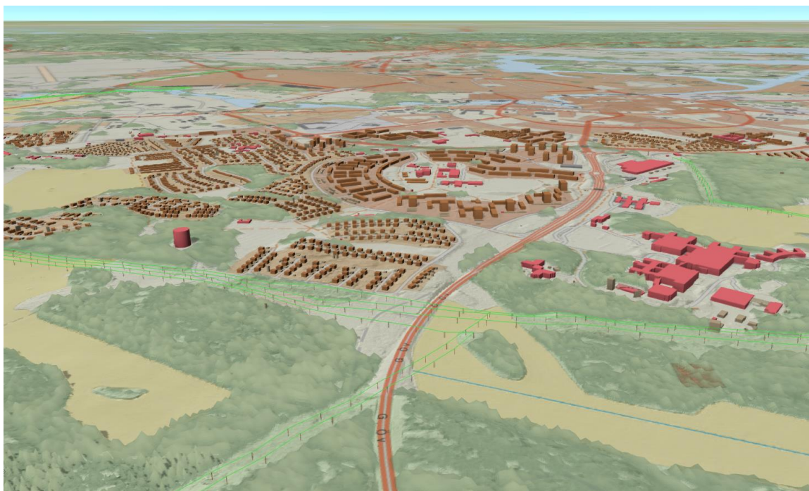
Figur 11f Lantmäteriets topografiska webbkarta, visning draperad på höjdmodell och kompletterad med objekt i 3D, t ex hus, kraftledning, skog. I figur 11e kan motsvarande vy ses i 2D.
