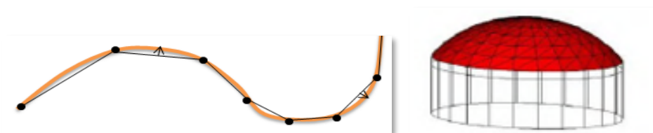
Figur 69 - Exempel på kordans höjd ("pilhöjden") vid registrering av en linje. Motsvarande gäller för fasader med rundade hörn, kupolformade tak osv.
