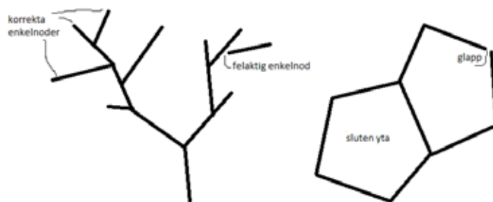
Figur 2.6. Kontroll av nätverkstopologi genom studier av enkelnoder (vänster). Kontroll av yttopologi genom analys av "glapp", dvs. öppna ytor (höger).
