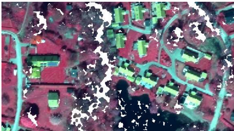
Figur 2: Där matchningen inte har lyckats blir det hål i ytmodellen. Hålen syns tydligt mot en vit bakgrund, men syns även i bilden på det här dokumentets framsida.
