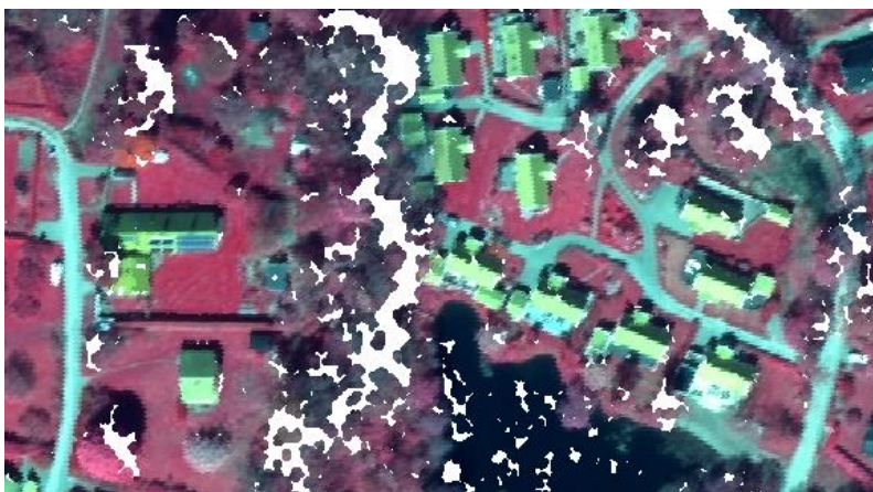
Figur 4. Där matchningen inte har lyckats blir det hål i ythöjdmodellen. Hålen syns tydligt mot en vit bakgrund, men syns även i bilden på det här dokumentets framsida.
