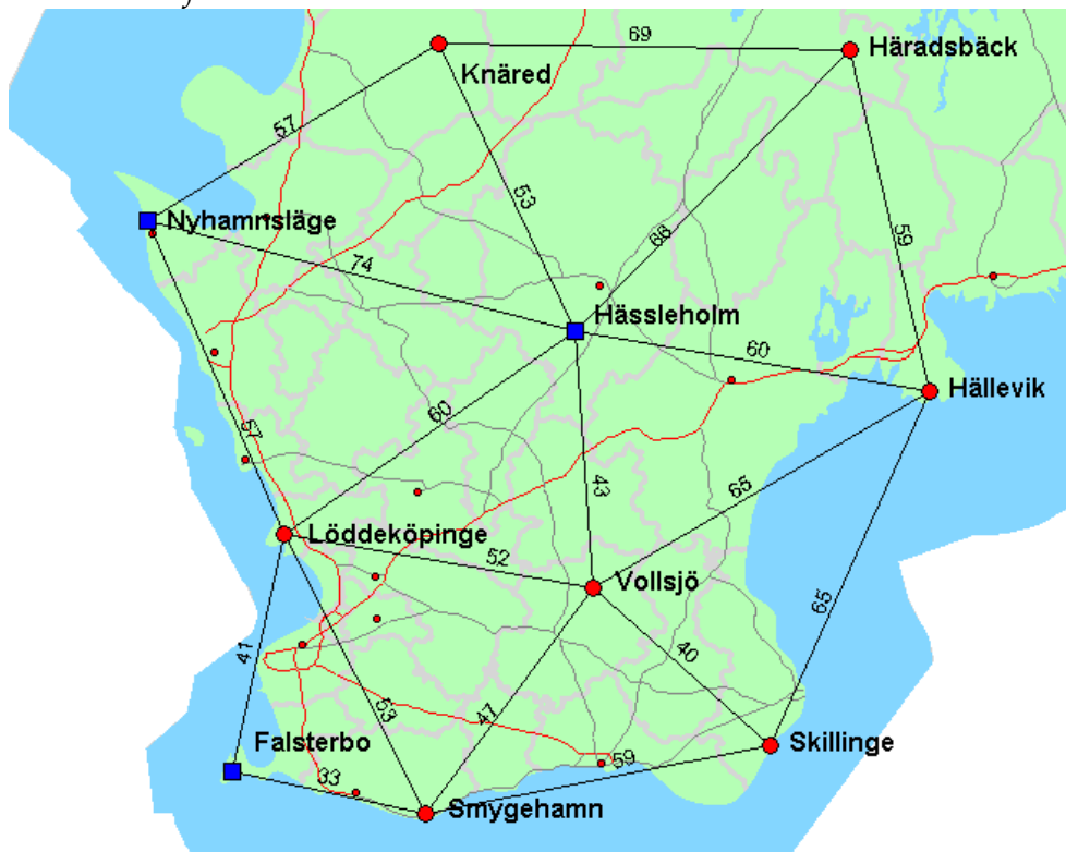
Figur 6: Nätutformning för SKAN-RTK – 2. Fyrkanter representerar befintliga SWEPOS-stationer. Cirklar symboliserar projektstationer, etablerade inför SKAN-RTK – 2.
