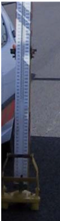
Figur 6: Avvägningsstång med nedersta 50 cm utan skalstreck
