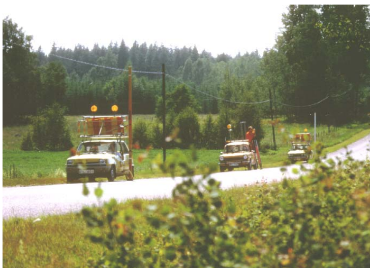
Fig 2. Uppställning vid motoriserad avvägning.
