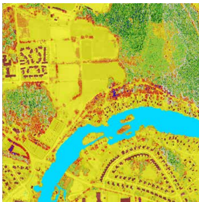
Bild 14. Lägesosäkerhet och grova fel – övriga objekt. Blå pixlar visar avvikelser större än (1+4*5) meter mellan punktmolnet och referensen NH-DSM. Färgskalan i övrigt som tidigare med 5 meters intervall.
