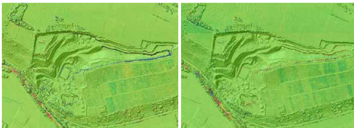
Bild 3. Ett utsnitt ur jämförelsen i Vaihingen/Enz. Till vänster resultatet från Match-T och till höger SURE. Färgskalan redovisar skillnader mellan <-2\text{m} >2\text{m} .
