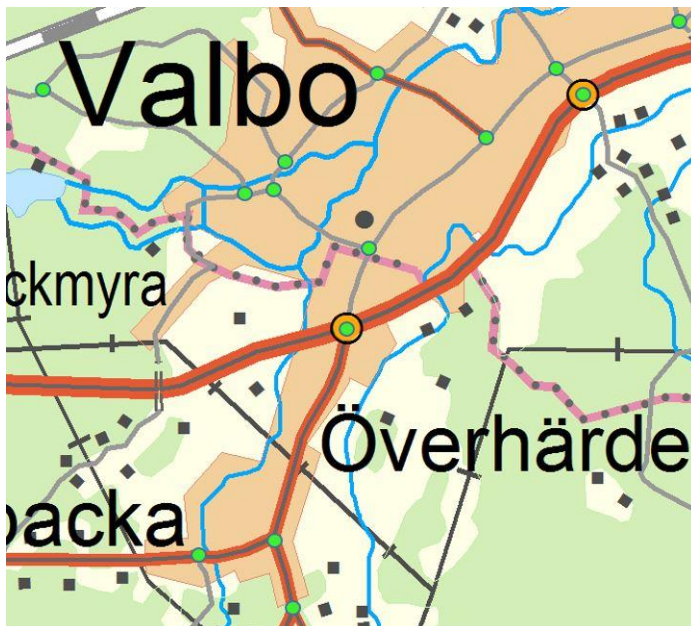
Figur 3. Ett geometriskt linjenätverk där vägarna är delade i anslutningspunkterna.
