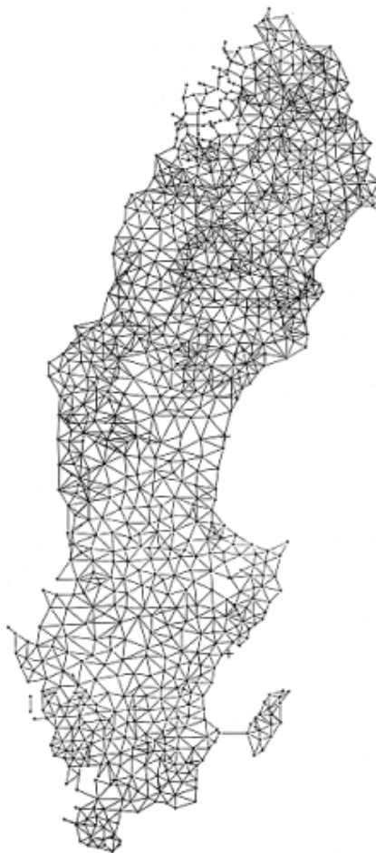
Figur 4.4.1.a: Rikets triangelnät 1990 som realiserar det äldre plana referenssystemet RT 90 är mätt som ett triangelnät med stor andel längdmätning ingående i nätet.
