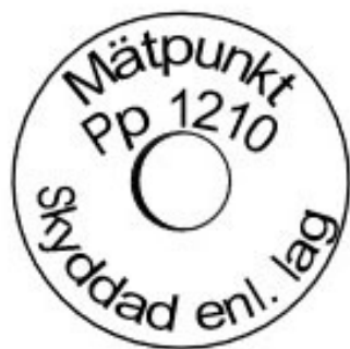
Figur 4.1.6.b. Exempel på märkning av stompunkt.
