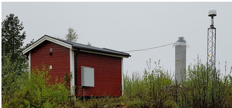
Figur 3.3.1.b. De 21 fundamentalstationerna har två antenninstallationer – på isolerad betongpelare samt på fackverksmast (vänster respektive höger i bild).
