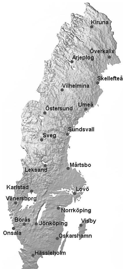
Figur 3.1.1. De 21 fundamentalstationer i SWEPOS-nätet som används för att definiera SWEREF 99. Avståndet mellan fundamentalstationerna är ca 200 km.
