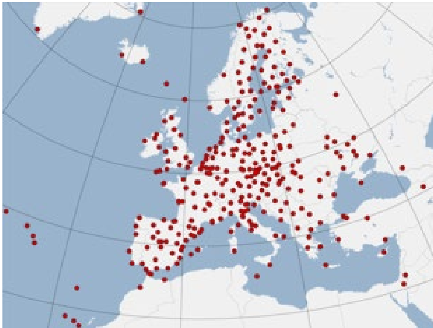
Figur 3.3.3. De fasta referensstationerna i EUREF Permanent Network (Källa: http://www.epncb.oma.be )
