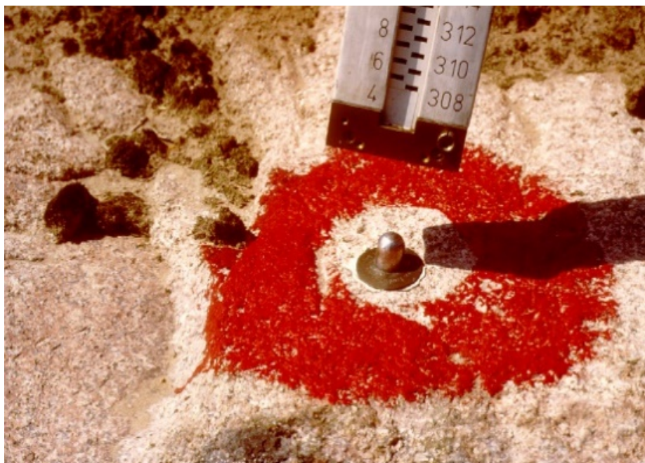
Figur 3.2.1.a. En typisk höjdfix i RH 2000-nätet.
